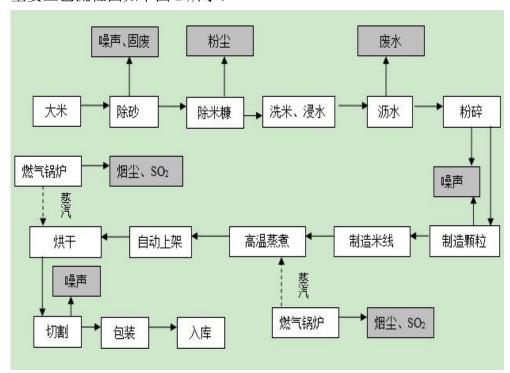
图 2 干米线生产工艺流程及产污环节图
