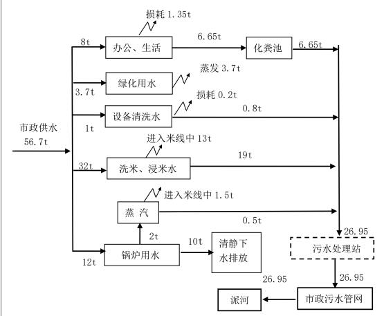
图 1 项目水量平衡图(单位: t/d)
