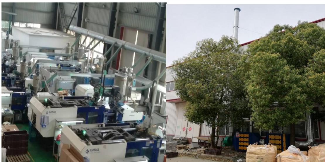
1#厂房注塑工序：集气罩+两级活性炭吸附装置+15m 高排气筒（DA001）
